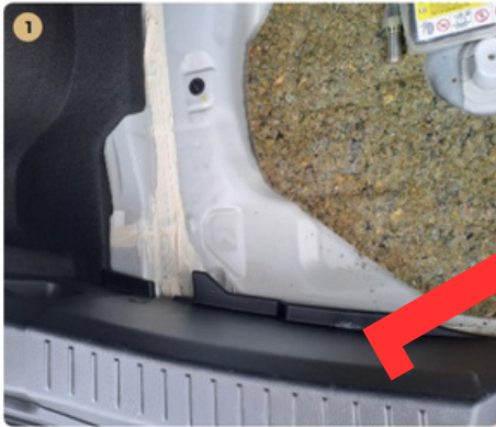
✓ Utascella és gyűrődő zónák A csomagtartó alatti fenéklemezen javításra utaló nyomok nem találhatók.
