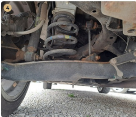
✓ Futómű A lengéscsillapítón olajfolyás nem észlelhető.
