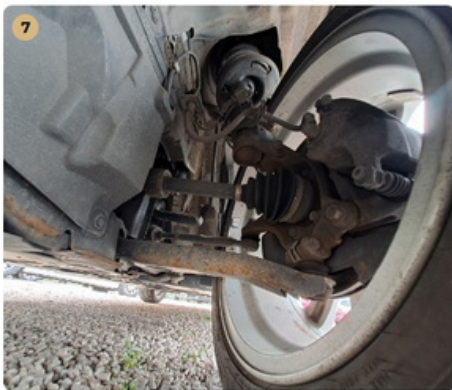
✓ Fékkrendszer A gumifékcsoveken repedés nem található.
