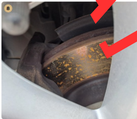
! Fékkrendszer Első féktárcsákon kezdődő vállasodás látható
