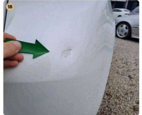
18 Külső karosszéria elemek Kisebb sérülés a hátsó lökhárítón
