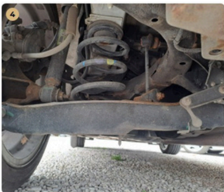
4 Futómű A lengéscsillapítón olajfolyás nem észlelhető.
