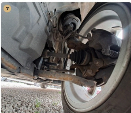
7 Fékkrendszer A gumifékcsoveken repedés nem található.
