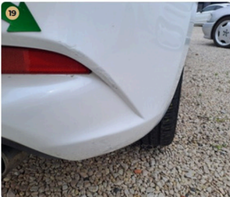
19 Külső karosszéria elemek Horzsolások a hátsó lökhárítón
