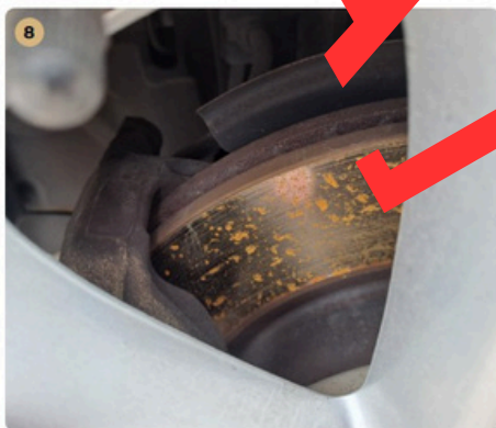
8 Fékkrendszer Első féktárcsákon kezdődő vállasodás látható.
