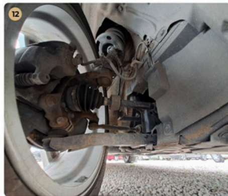
12 Hajtás A féltengely gumiharangoknál szakadást nem észleltem.
